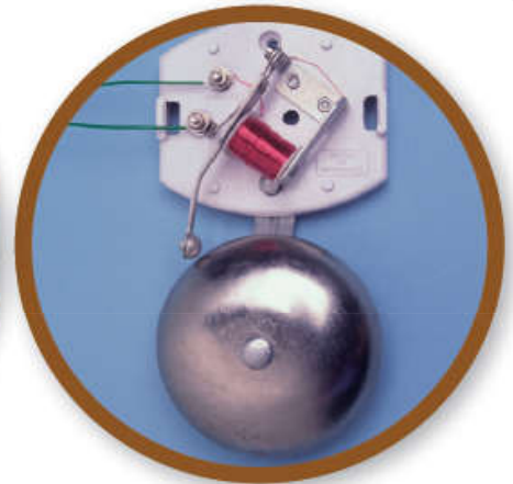
يحتاج هذا الجرس الى جهد كهربائي (6V) ليعمل.
